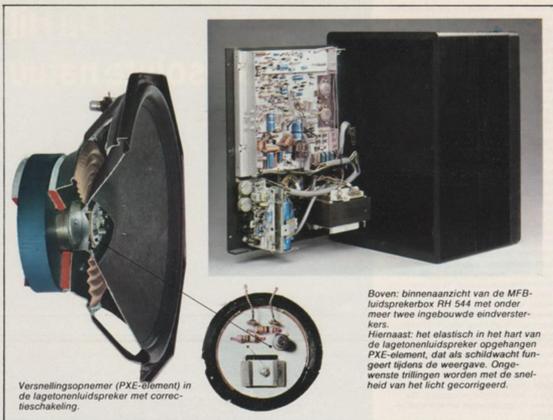
Luidsprekeropstelling MFB-boxen, RH 541 en RH 544.
