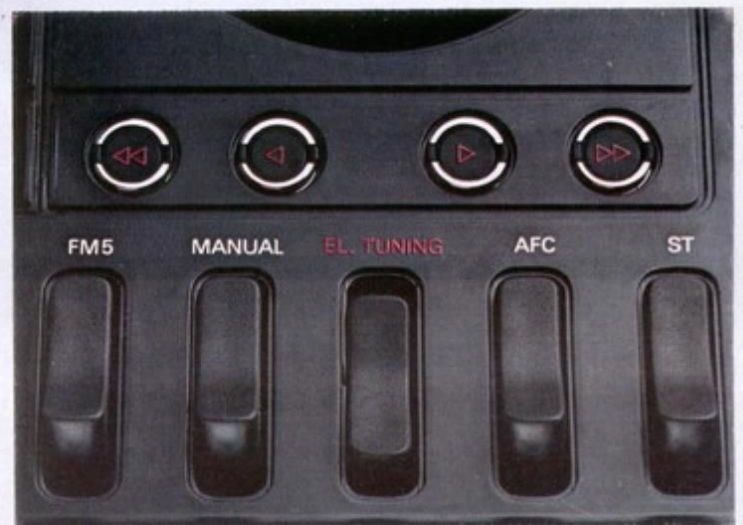
Automatisch FM-zender zoekstelsysteem, gekoppeld aan vier elektronische tiptoetsen, resp. voor normaal of versneld kiezen naar links of naar rechts.
