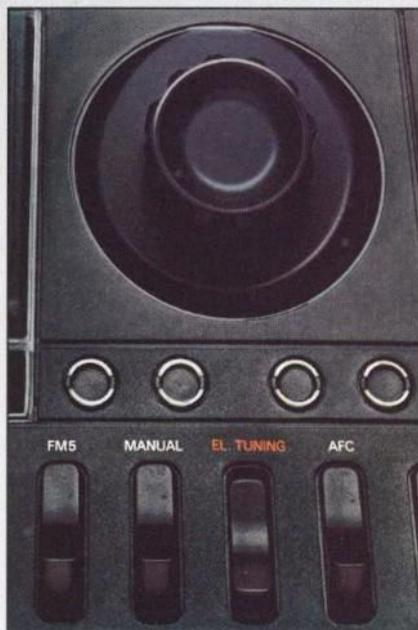
Automatischer Sendersuchlauf im UKW-Bereich, gesteuert über elektronische Sensoren. Beim Antippen der Sensoren wird das UKW-Band durchlaufen, wahlweise langsam oder schnell. Berührt man die Sensoren nicht mehr, stoppt der Suchlauf automatisch auf den nächsten Sender ab und stellt ihn mit der integrierten Scharfabstimmung optimal ein.
