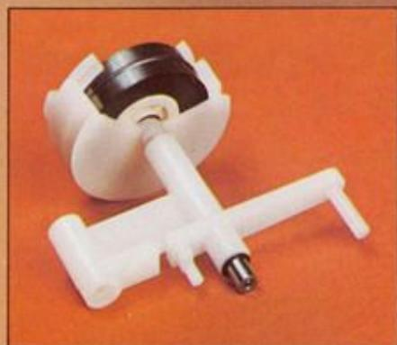
Die verschleißfreie Hysterisis-Friktion (magnetische Kupplung) sorgt für ein weiches und konstantes Drehmoment zum Aufwickeln des Bandes.
