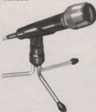
LBB 9500 Dynamische HiFi-microfoon. Frequentiebereik: 40-19.000 Hz. Gevoeligheid: 0,27 mV/ \mu bar. Impedantie: 500 \Omega . Compleet met tafelstatief.
