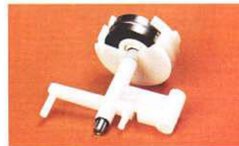
Hysteresekoblingen giver en korrekt og ensartet båndstramning.
