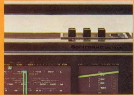
3 UKW-Stationen drucktasten mit separater Skala
