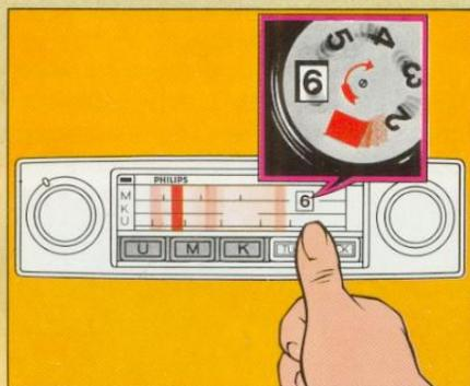
Hier werden nach dem Prinzip eines Trommelmagazins sechs Sender auf einer Taste gespeichert. Damit können Sie Sender gemischt aus dem UKW-, MW- oder KW-Bereich vorher festlegen und nacheinander abrufen. Der Wechsel von Musik zu
