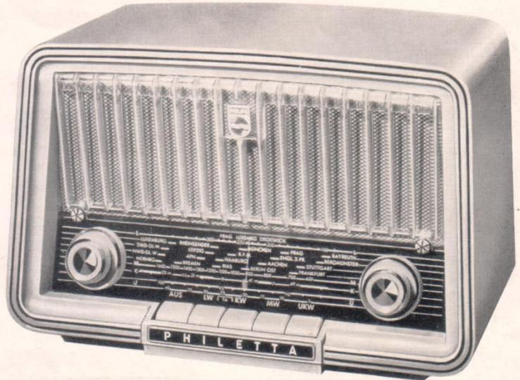
6/11 Kreise, 6 VALVO-Röhren mit 12 Funktionen, 5 Drucktasten, 4 Wellenbereiche, Ratiodektor, Duo-Oval-Lautsprecher, kontinuierliche Klangregelung, Ferroceptor und UKW-Drahtwurfantenne, Anschluß für Zweitlautsprecher und Tonabnehmer. Abmessungen: 285 x 181 x 116 mm, Gewicht: ca. 3 kg. Abmessungen de Luxe: 335 x 192 x 170 mm. Abmessungen Phono: 408 x 356 x 203 mm, Gewicht: 4 kg
