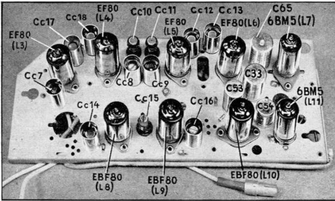
faire, sur chaque position, l'accord de l'oscillateur ( $C_{18}$ ). Rappelons que ce réglage doit se faire de façon à avoir le maximum de sortie son.
