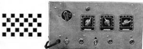
Cet appareil, destiné au laboratoire de dépannage et de mise au point, fournit un signal V.F. complet dont les caractéristiques sont, à l'entrelacement près, identiques à celles du standard français.
