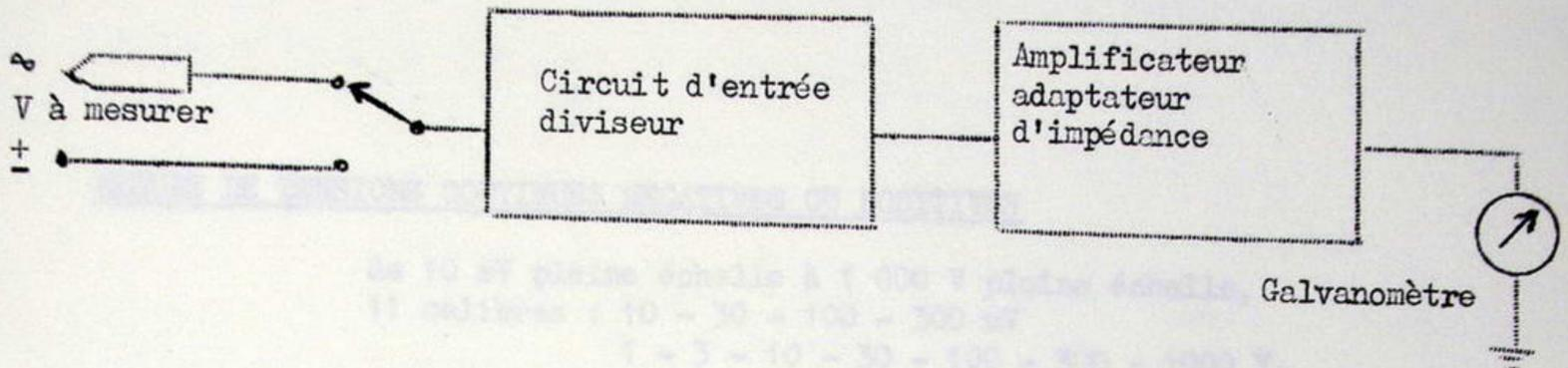
1°) - L'étage d'entrée à grande impédance et faible courant résiduel de grille est équipé d'un diviseur et d'un tube nuvistor à haute stabilité. Dans le cas de mesure en alternatif, le circuit d'entrée est précédé d'un redresseur à diode thermoïonique qui présente les avantages suivants :
