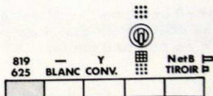
La partie inférieure de l'image permet d'effectuer le contrôle de la définition. Le signal de définition est en effet un signal délivré par un oscillateur de fréquence comprise entre 3 et 9 MHz. La commande Q permet de faire varier cette fréquence dans la bande indiquée.
