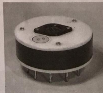
Figure 6. — Camembert avec support E5 pour triode genre A409.
