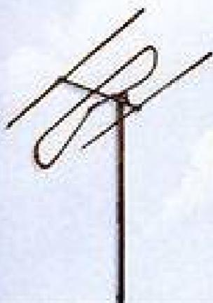
**10933.** 3 éléments : brin directeur, folded et réflecteur. Démontable. Dural. Fixation standard. Gain 7 db. 5. Directivité 61° à - 3 db. Bande passante 14 Mc/s à - 1 db. Impédance 75 ohms.
