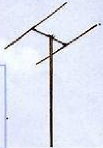
**10932.** Doublet. Démontable. Dural. Fixation standard. Gain 5,5 db. Directivité 66° à - 3 db. Bande passante 14 Mc/s à - 1 db. Impédance 75 ohms.
