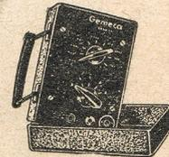
CHARACTERISTIQUES : atténuateur gradué (tension de sortie constante) 7 points fixes H.F. Une émission B.F. atténuable. Une émission en « MULTIVIBRATEUR », c'est-à-dire couvrant sans trous toutes les fréquences depuis les G.O. jusqu'aux O.C. Blindages très étudiés. Fuites infimes, alimentation incorporée.
