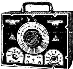
Oscillateur. HAUTE FREQUENCE EN MONTAGE « Feed Back » de 100 kcs à 30 mcs sans trous (3.000 m. à 10 m.), module à 400 périodes par la plaque.
