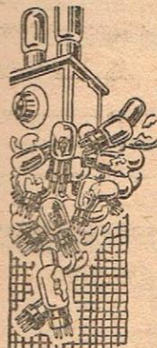
ampoule brisée filament brûlé ou soudé plaque et grille détachées culot détérioré
