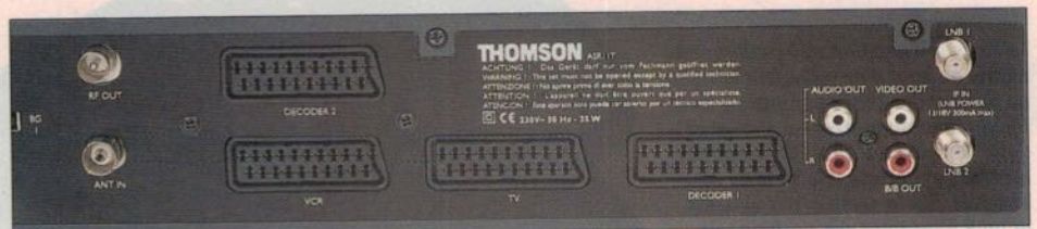
La face arrière du récepteur Thomson révèle une très belle collection de prises dont quatre Scart et une sortie RCA en bande de base...
