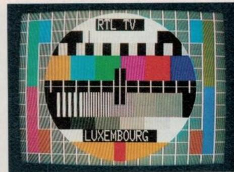
Aspect d'image, cette fois-ci, avec une parabole de 40 cm de diamètre. Le rapport signal/bruit est meilleur de 2,5 dB. Pour -20 dB et cette qualité, le diamètre vaut 4 mètres.
