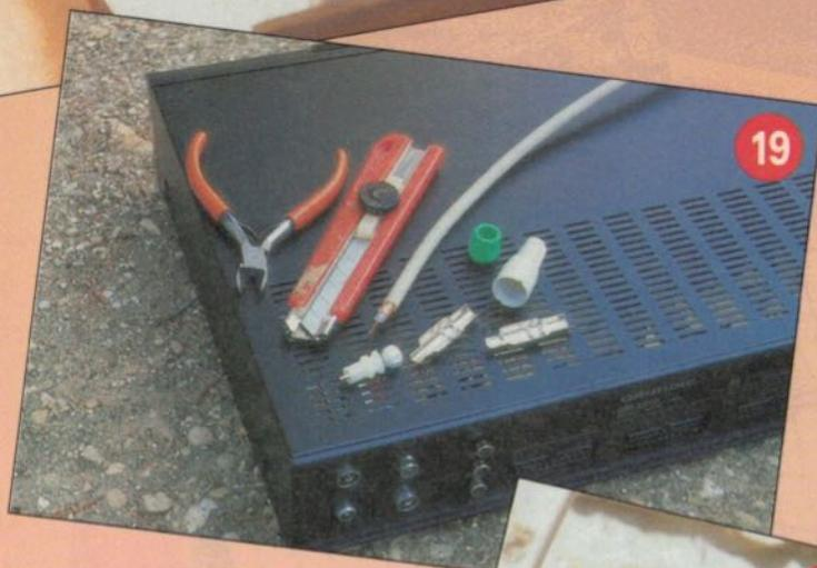
**19** Le câble est dénudé à la longueur, on le dépouille pour installer une fiche CEI, prise correspondant à celle du récepteur Grundig. L'opération est délicate si on ne dispose pas d'un outillage spécialisé. Beaucoup de fabricants de récepteurs satellite préfèrent la prise F, moins courante, mais assurant une meilleure continuité entre le câble et le tuner.
