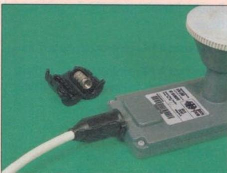
Comment assurer une étanchéité au niveau de la tête. Une technique d'origine hollandaise. La coque est remplie d'une matière plastique ayant la consistance d'une gelée et moulant parfaitement la connexion.
