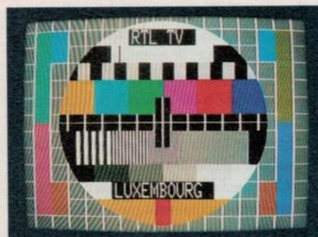
Aspect d'image au centre de la zone (56,6 dBW) avec une parabole de 30 cm de diamètre ayant un gain de 30 dB. L'image est déjà propre (acliquée), cependant, le rapport S/B vidéo est à notre avis insuffisant, mais tout à fait commercial. Si la décroissance du signal est de 20 dB, le réflecteur passe à 3 mètres pour conserver la qualité référencée.
