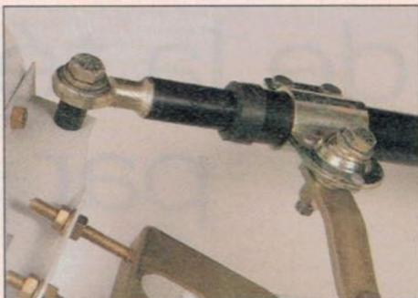
Le vérin d'une antenne motorisée comporte un joint glissant que l'on ne peut lubrifier avec n'importe quelle huile ou graisse. Une protection par un joint à soufflet peut s'avérer utile en ambiance difficile. Vérifiez aussi la présence de points de rouille pour les éliminer... Graisser si nécessaire les articulations.
