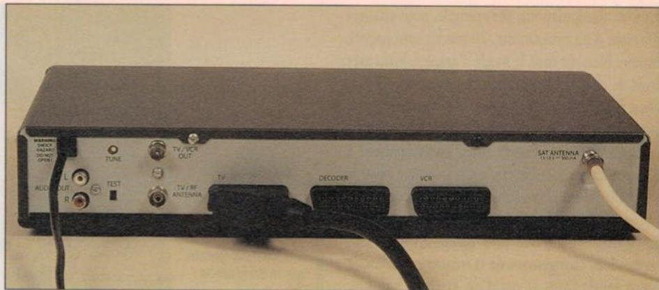
La face arrière avec les trois prises nécessaires au raccordement du téléviseur, d'un décodeur et d'un magnétoscope.
