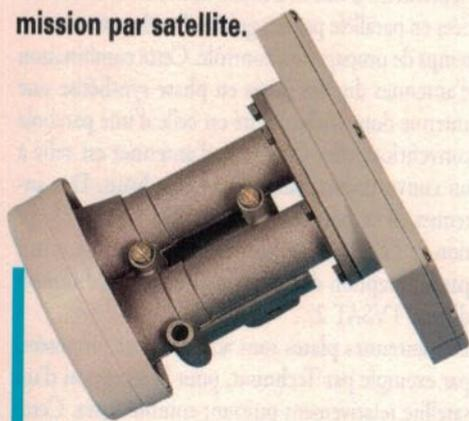
Tête siamoise pour deux satellites distants de 3°, deux têtes sont juxtaposées et on ne sort que sur un seul câble. Les deux bandes de Telecom, identiques, sont multiplexées en fréquence, à l'entrée du récepteur satellite.
