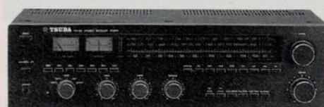
**AMPLI TUNER PO GO FM OC - 2 X 40 W** Eff. 4 Ω - Entrées : Tape 1, Aux/CD, Phono, Tape 2 - Filtre Haut et Bas - Loudness - AFC - 3 stations pré-réglables en FM stéréo - gammes d'ondes Courtes (13 à 49 m).
