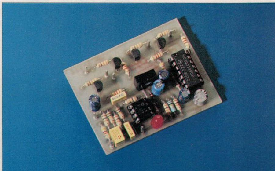
changeront d'état en fonction de la musique. Une tension de 5 V suffit à assurer l'alimentation de cette section, on peut éventuellement alimenter le montage par trois ou quatre piles de 1,5 V.
