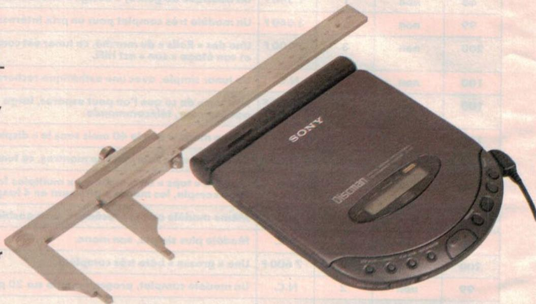
cats vernis... La manipulation ne demande pas d'effort, les plus importants étant nécessités par l'ouverture et surtout par l'extraction du CD. Ce dernier est verrouillé par trois ressorts situés au centre du plateau (Sony n'utilise pas ici de presseur). Une touche verrouille les touches mais pas l'ouverture du logement du CD. Nous avons ici les modes classiques d'exploration d'un CD : lecture, avance par plage ou progressive
