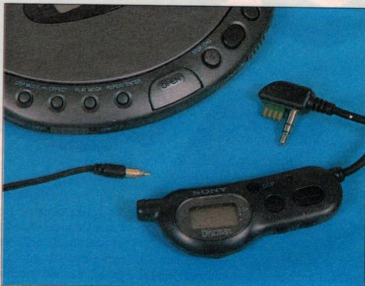
Une télécommande infrarouge ultraplate accompagne le SL-XPS900, les ondes sont reçues par le capteur latéral. Une seconde télécommande, par fil, existe également, elle est installée sur le fil des écouteurs.
