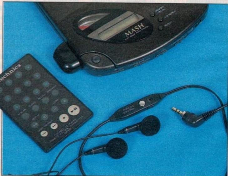
exigée. Un clavier numérique à douze touches (il y a une touche 10 et une de dizaines) facilite la recherche des plages et surtout leur programmation. La télécommande reprend une partie des fonctions de l'appareil et ajoute le balayage des « intros » avec échantillonnage de 15 secondes par plage ainsi qu'un réglage de niveau affecté aux sorties casque et ligne.
