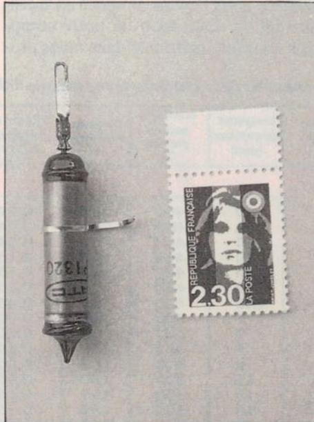
Le tube Geiger-Müller utilisé dans notre compteur.
