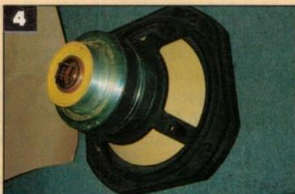
**4** Dernière invention : le MVF, moteur à compensation de quantité de mouvement, qui ne vibre pas. On voit ici le moteur de compensation, calibré en masse individuellement.
