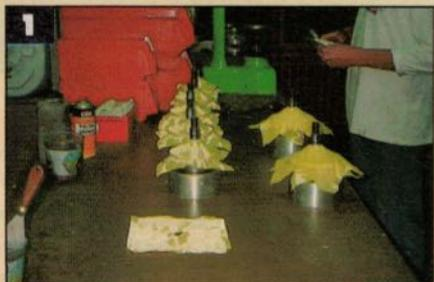
**1** Les cônes à profil semi-exponentiel en Polykevlar sont faits à la main, où l'opérateur veille à l'absence de plis. Pour les cônes à génératrice rectiligne, une presse suffit.
