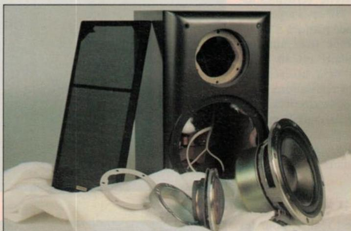
**Ci-contre, tout ce qu'il faut pour la Monitor 500X. Remarquer la bague support de tweeter, en alu moulé, et la double ferrite. En bas, le filtre, réalisé en deux parties.**
