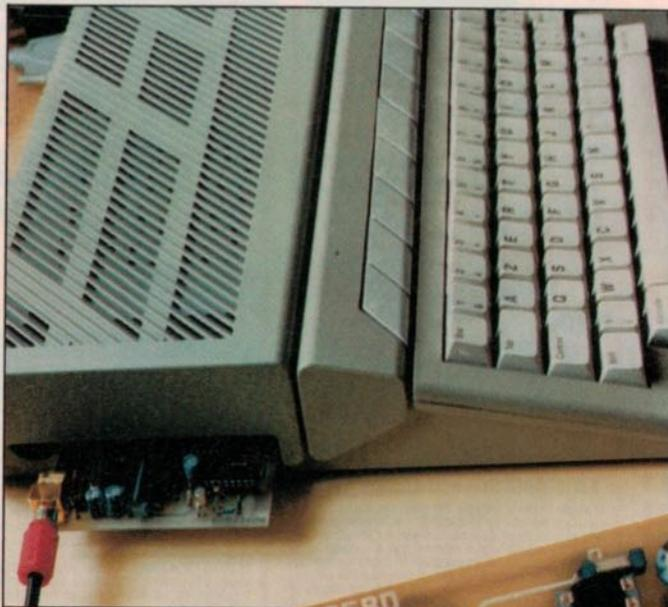
Ci-dessus : l'interface mis en place sur le ordinateur Atari. Ci-contre : la platine interface ADC (vue du dessus).
