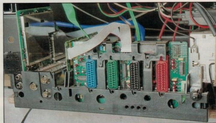
Les scarts alignées à l'arrière. Tout est possible, à condition de ne pas se tromper.
