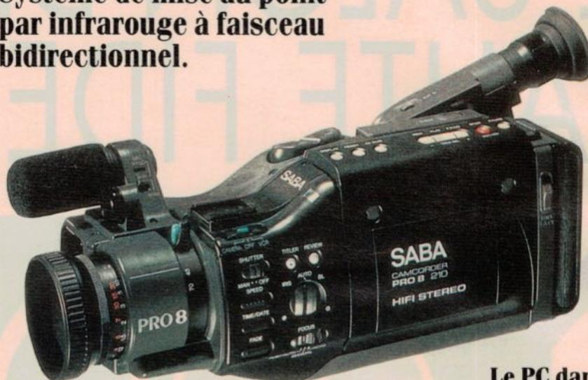
Le système de mise au point automatique par infrarouge de ce camscope 8 mm Saba utilise un faisceau bidirectionnel qui permet de mettre au point sur des sujets non placés au centre du viseur. Ce Saba Pro 8 210 est équipé d'un zoom 8 x 8,7-70 mm F : 1,4 et d'un CCD à 320 000 pixels.
