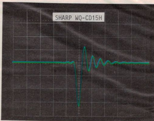
Réponse impulsionnelle. — Là, on remarque, en avant de l'impulsion, les oscillations propres au filtrage numérique. Notez la polarité de l'impulsion de sortie, elle dépend du nombre d'étages utilisés en sortie. Echelle : 0,5 V/100 \mu s/division.
