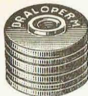
Intéressante pour la haute fréquence et pour ondes longues de 1000 à 2000 mètres parce que l'on a, par rapport à la cuvette, une carcasse de bobine plus grande, permettant un enroulement plus important. La plus petite capacité propre de la bobine (pour 0,2 mH, environ 4 cm) fixation de l'ensemble et déplacement de la vis de réglage en « DRALOPERM » à l'aide du tube en trolitul. Possibilité de régler l'inductivité de 8-9 %.
