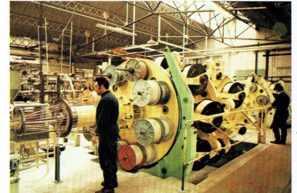
Assembleuse à cages tournantes pour câbles à paires coaxiales 1,2/4,4 à isolation « Ballon »
