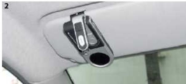
La position du microphone peut varier de 0° (appareil éteint) à 55° ou 210° (appareil allumé) en fonction de la position du pare-soleil.
