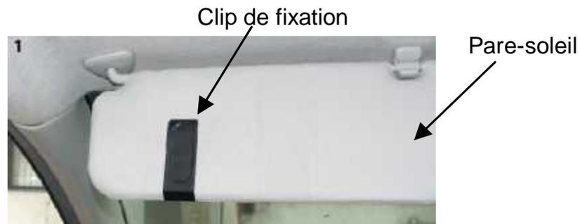
Positionnez la partie aimantée de votre SuperTooth II sur le clip métallique. Le SuperTooth II doit être placé face à vous sur le pare-soleil. Placez le microphone de façon à ce qu'il soit dirigé vers vous.
