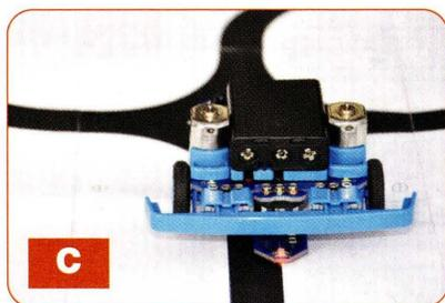
Veillez au sens d'insertion du connecteur (une erreur inverse les polarités de l'alimentation du module).
