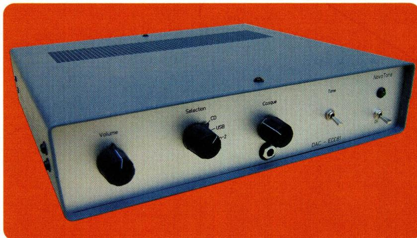
Ce préamplificateur a été conçu pour «piloter» tout amplificateur de qualité audiophile. Il met en œuvre deux doubles triodes ECC81 / 12AT7 et une double triode ECC99. Il permet la sélection de deux sources numériques, deux sources analogiques et dispose d'un gain programmable de 12 dB.
