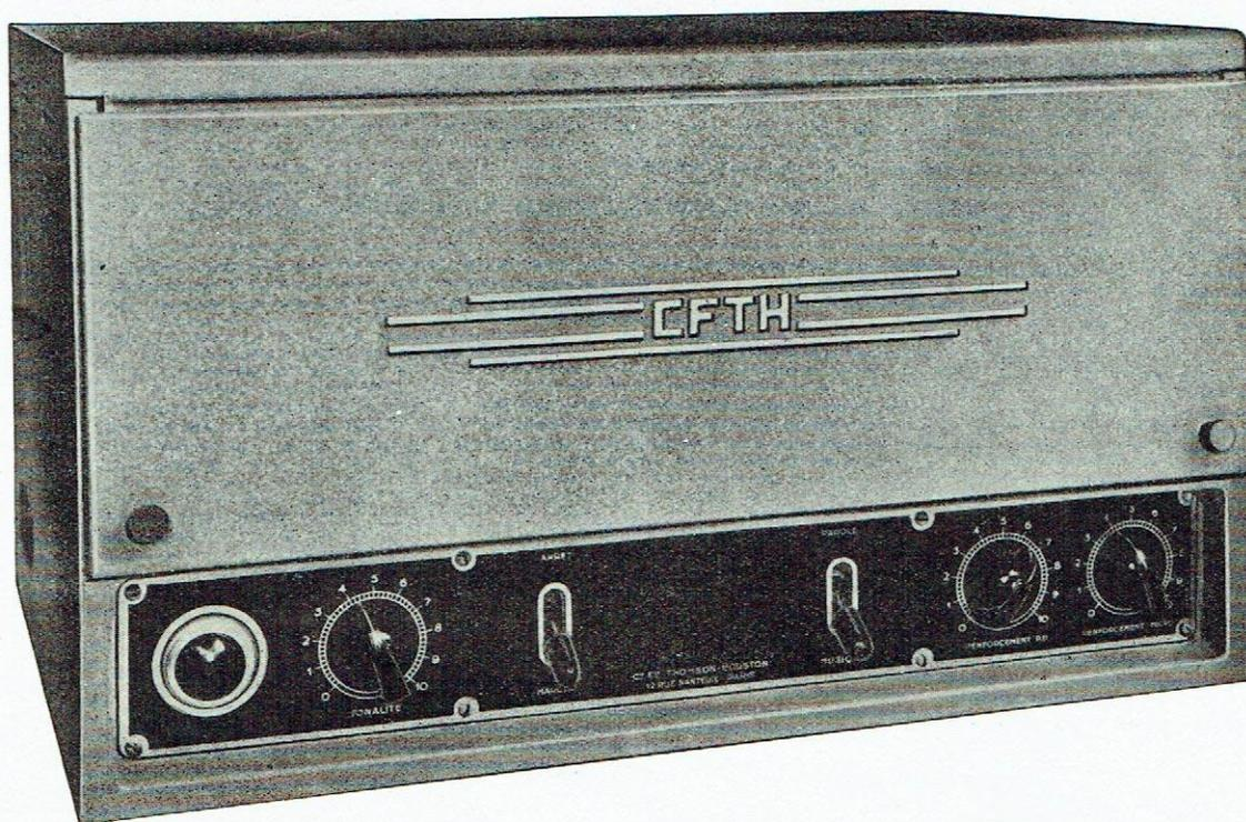
Puissance modulée : 40 watts.
