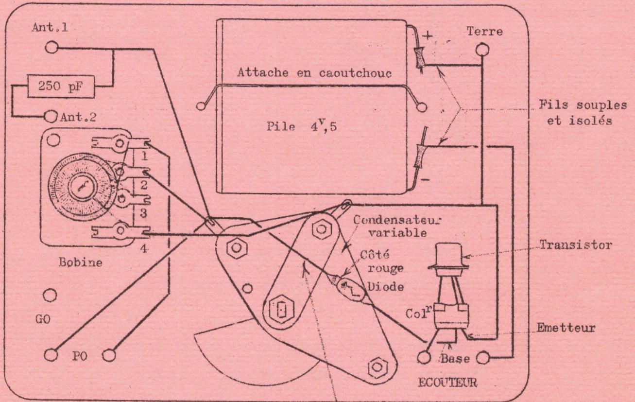
Attention le fil de la diode ne doit pas être en contact avec la bande de masse du C.V.
