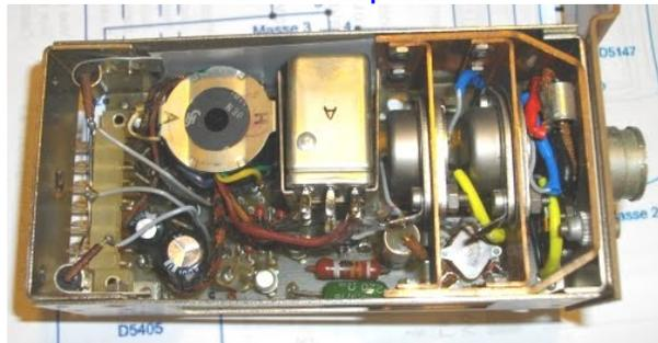
**Remarque :** les condensateurs 22µF/100-125V, 4,7µF/100V et 22µF/25V étaient secs. Il y avait un léger amorçage entre une connexion du pot ferrite et le blindage. Mis une feuille isolante entre les deux. Malgré ces défauts, l'appareil fonctionnait.
