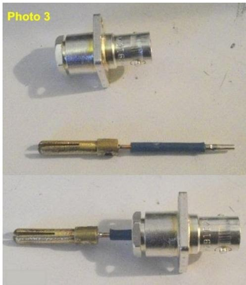
Percer 4 trous de 2.5 mm et tarauder pour 4 vis de 3 mm et fixer la BNC.
