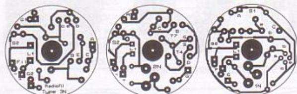
Le typon : (largeur 90 mm environ) à photocopier (sur transparent de rétro-projection) pour insoler le circuit imprimé photosensible. Vue côté cuivre.
