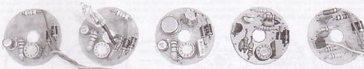
Les 5 modèles de CI câblés et prêts au montage à l'intérieur du support de la lampe.
