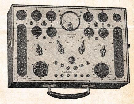
Analyseur point par point avec cordon, bouchons intermédiaires et cartes pour manœuvre automatique (225 combinaisons). (Voir détails à ALEX)
