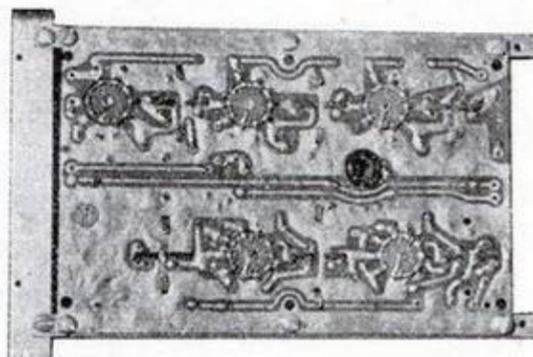
Transformateur M.F. et platine imprimés ARENA.
