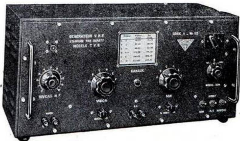
Ce générateur V.H.F. à points fixes a été conçu et réalisé spécialement pour l'étude, la mise au point et le dépannage des récepteurs modernes de Télévision. Associé à un générateur d'image, il fournit, dans les gammes 40 à 225 Mc/s, six canaux de Télévision, image et son, dont les porteuses sont pilotées par quartz.
