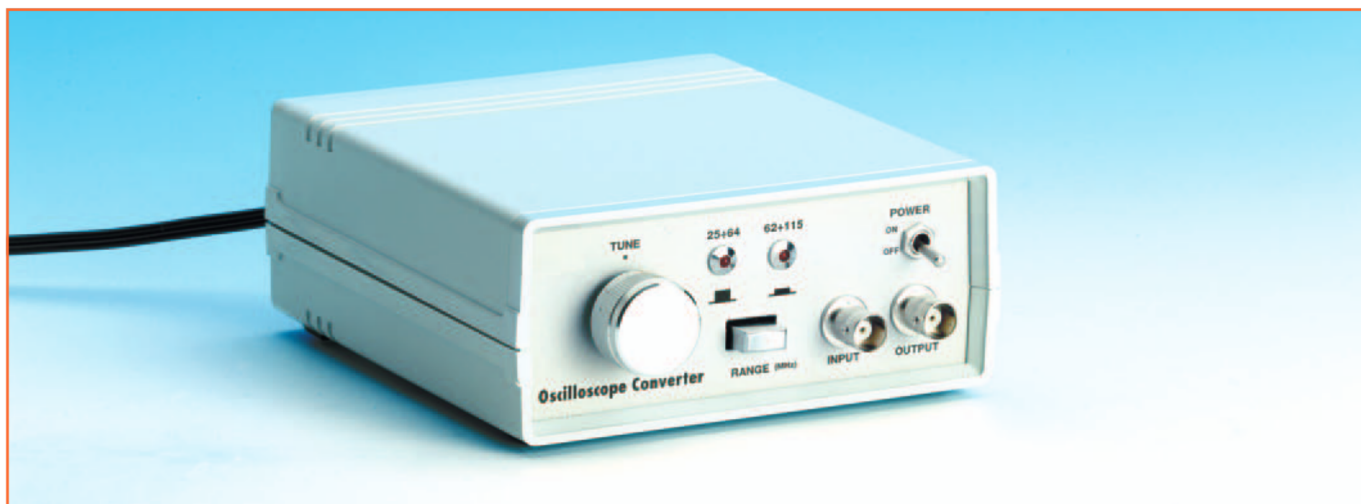
Figure 6 : Après réalisation, la platine est installée dans un boîtier plastique avec face avant et panneau arrière en aluminium anodisé. Le bouton commande le potentiomètre R8 d'accord et le poussoir rectangulaire le commutateur S1A et S1B de changement de gammes de fréquences (dont les LED témoignent).
