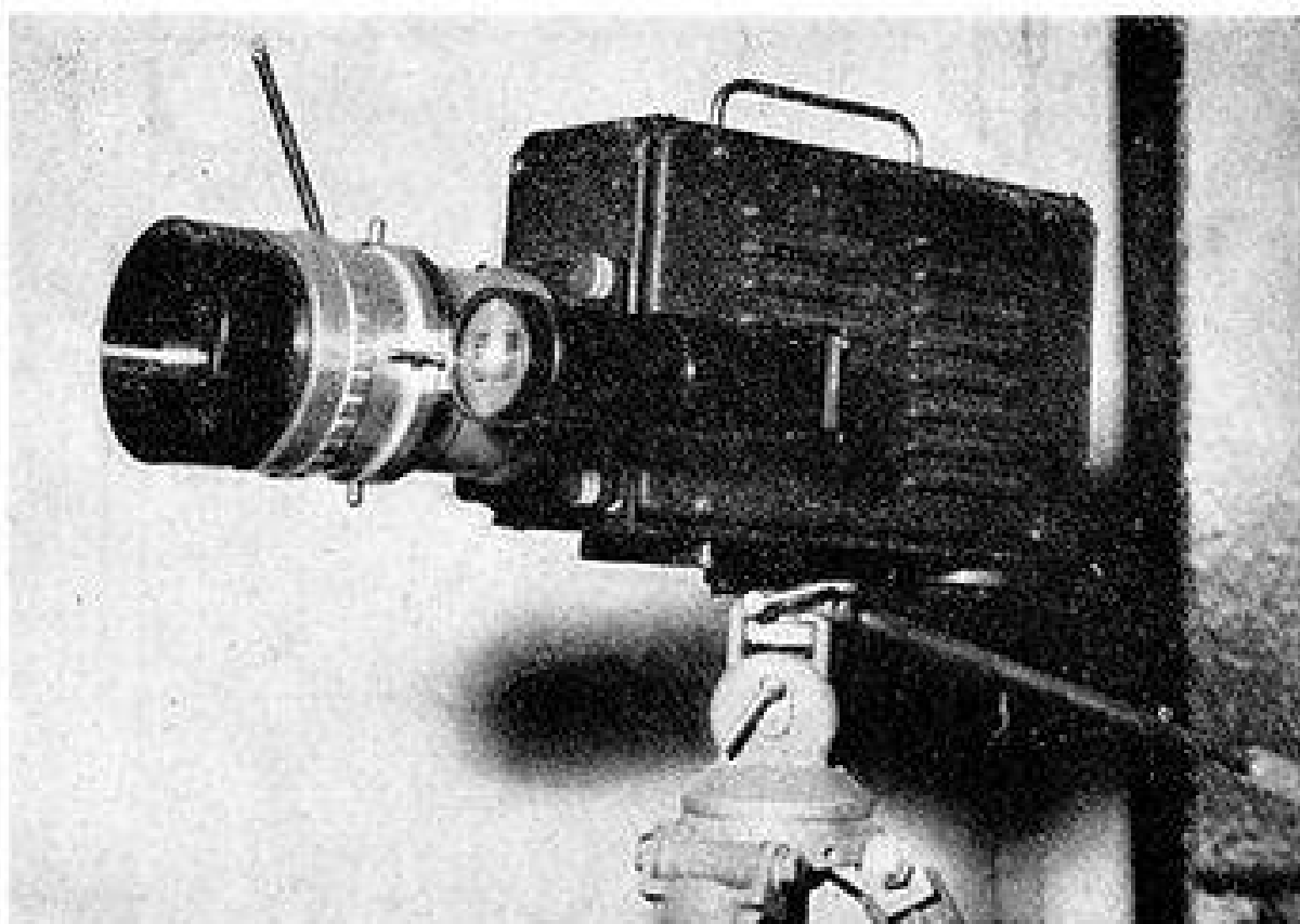
Caméra à tube vidicon montée avec un objectif à focale variable couplé à un viseur à champ correspondant.
