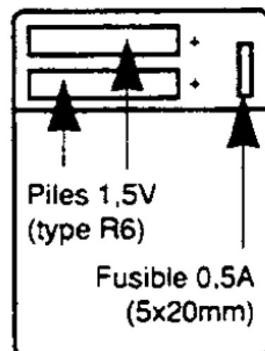
**ATTENTION :** En cas de remplacement de fusible, il est impératif de respecter sa valeur et son type sous risque de détérioration de l'appareil et d'annulation de la garantie.
