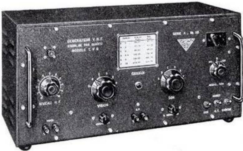
Ce générateur V. H. F. à points fixes a été conçu et réalisé spécialement pour l'étude, la mise au point et le dépannage des récepteurs modernes de Télévision, Associé à un générateur d'images, il fournit, dans les gammes 40 à 225 Mc/s, six canaux de Télévision, image et son, dont les porteuses sont pilotées par quartz.
