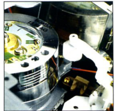
Nettoyage automatique des têtes.
