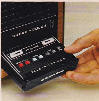
LOGEMENT DE LA TP 80 E
