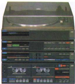
80/50 Watt je Kanal. 5fach-Equalizer. Automatische Programmquellen-Umschaltung. Quarz-Synthesizer-Tuner mit UKW, MW, LW und 14 Festsendern. Doppel-Cassetten-Deck mit High-Speed-Dubbing. Dolby-B. Vollautomatischer Belt-Drive-Plattenspieler.
