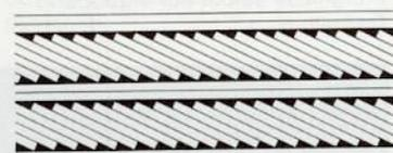
Die Aufzeichnung selbst erfolgt beim VCR-System VIDEO 2000 im Schrägspurverfahren, wobei die einzelnen Spuren dicht an dicht, also ohne Zwischenräume, liegen. Bei der Aufzeichnung wird nur die Hälfte des 12,7 mm breiten Magnetbandes verwendet, so daß die Video-Cassette nach Durchlaufen des Bandes umgedreht werden kann und nochmals die gleiche Spielzeit zur Verfügung steht (wie es bereits von der Audio-Compact-Cassette her bekannt ist).
