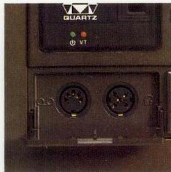
**Zwei Audio-Buchsen sind auch vorhanden:** Eine davon ist für den Anschluß eines Kopfhörers. Je nachdem, wie Sie den Stecker einstecken, wird dabei der Geräte-Lautsprecher abgeschaltet, oder nicht. Die zweite Buchse ist für den Anschluß eines Cassetten-Recorders. Zum Beispiel, wenn Sie den Ton einer interessanten Musiksendung auf Compact-Cassette mitschneiden wollen.
