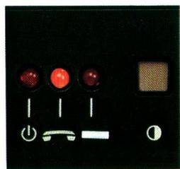
**Eine Automatik sorgt für optimale Kontrasteinstellung:** Ob Sie bei Tageslicht fernsehen, abends bei Zimmerbeleuchtung oder im abgedunkelten Raum – die Ideal-Kontrast-Automatik des ITT Ideal Color 3660 BVT 02 sorgt permanent für eine optimale Kontrasteinstellung entsprechend der Umgebungshelligkeit. Das kleine gelbe Rechteck (Abbildung oben) ist der Ideal-Kontrast-Sensor.
