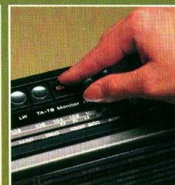
2. Wählen Sie das entsprechende KW-Band und drücken Sie die Taste »CD-Monitor«. Jedes Drehen an der KW-Abstimmung wird jetzt vom Digital-Computer des Gerätes genau verfolgt.
