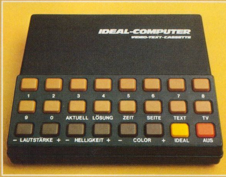
VIDEO-TEXT -Bedienungs-Cassette von ITT zur Steuerung von Fernsehprogramm und Bildschirmzeitung (Bestandteil eines Nachrüstsets).
