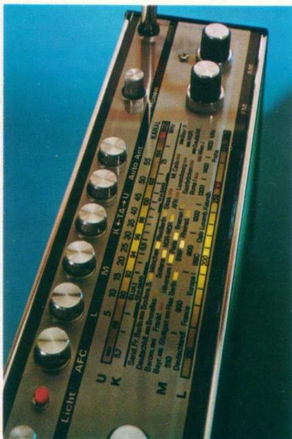
Was sofort auffällt: Zwei Bedienungsknöpfe für UKW und die übrigen Wellenbereiche. Das ermöglicht den Wechsel zwischen zwei Sendern durch Druck auf die Wellenbereichstasten.
