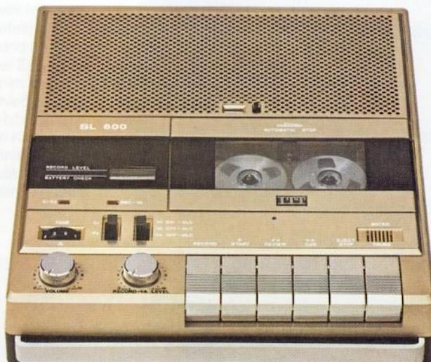
Das Gerät, das sich von selbst ein- und ausschaltet. Durch den eingebauten Voice Activator. Ein kurzes Händeklatschen, ein Wort oder ein Geräusch genügt, und er schaltet automatisch auf Aufnahme. Sechs Sekunden Stille sagen ihm, daß er wieder abschalten kann. Die Empfindlichkeit dieses akustischen Schalters läßt sich stufenlos einstellen.
