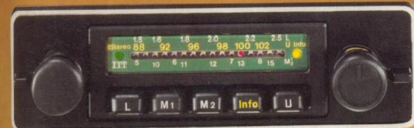
Das faszinierende an diesem Autosuper: ein Druck auf den Startknopf, und der rote Leuchtpunkt gleitet über die Skala, der Selectronic-Suchlauf stellt in Bruchteilen einer Sekunde den nächsten Sender optimal ein. (Durch einen mitgelieferten Fußschalter kann der Suchlauf auch mit dem Fuß ausgelöst werden.) Durch die Anwendung modernster Electronic ist es gelungen, in diesem Gerät hohen Komfort und einfache Bedienung zu ver-
