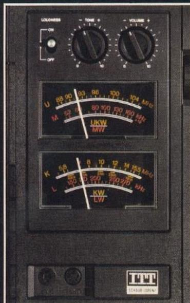
Eine Besonderheit des RCX 75 professional sind die beiden bei Netzbetrieb beleuchteten Instrumentenskalen für die Senderabstimmung. Auf ihnen sind jeweils zwei Wellenbereiche übersichtlich angeordnet.
