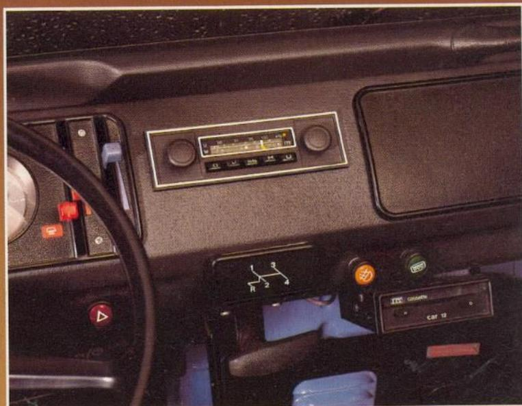
Der eingebaute Verkehrsfunk-Decoder macht diesen Zweibereichler (UKW/MW) zu einem preiswerten Verkehrswarnfunk-Empfänger.
