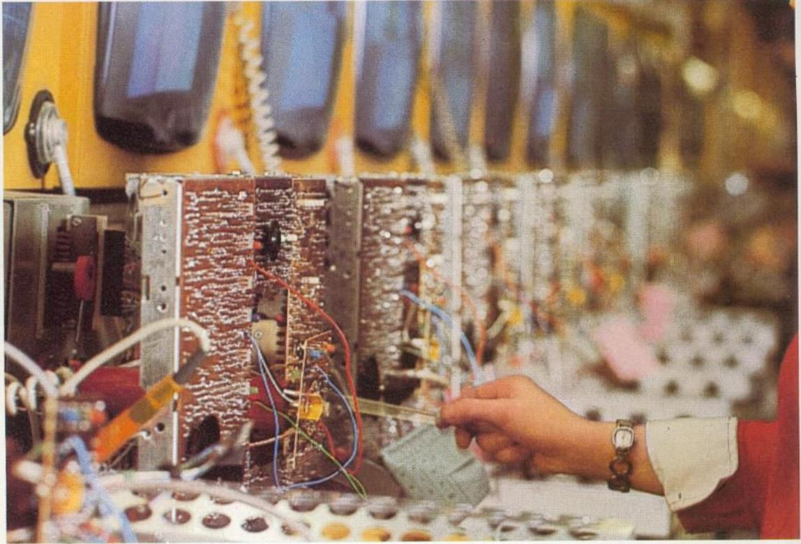
Alle Chassis durchlaufen vor dem Gehäuseeinbau eine umfassende Endkontrolle, in der sie auf alle Funktionen und beste Bildqualität untersucht werden. Fertige Produkte der laufenden Serie werden einem nochmaligen Dauerlaufstest unterzogen. Hier werden täglich, wöchentlich und monatlich ständig neue Geräte eingesetzt. Sie laufen zum Teil bis zu 1000 Stunden. Eventuell auftretende Schwachstellen werden sofort erkannt und können so während der Serie korrigiert werden.
