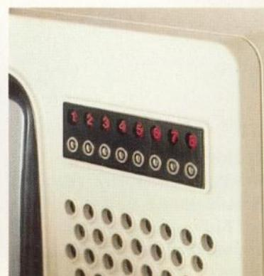
Programmwahl durch TV-Sensor. Das bedeutet: keine verschleißanfällige Mechanik – nur noch zuverlässige Elektronik! Eine sanfte Berührung einer der Sensor-Flächen genügt, schon wechselt das Programm.
