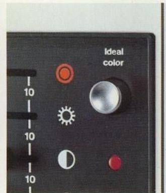
Eine Besonderheit dieses Farbfernsehgerätes ist die „Ideal-Color“-Taste. Sie übernimmt automatisch eine Ideal-Einstellung von Kontrast und Farbstärke. Ein einziger Tastendruck genügt. Die Programmwahl erfolgt durch eine hauchzarte Berührung einer der acht Sensor-Flächen.
