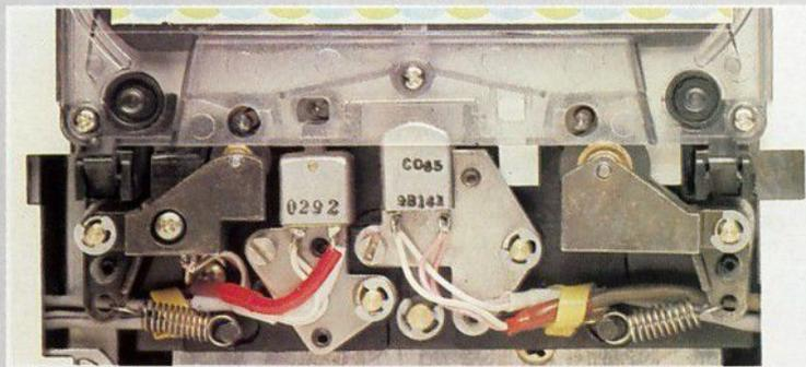
Die erreichbaren Gleichlauf-Werte eines Cassetten-Tape-Decks werden in erster Linie durch Konstruktionsprinzip und Präzision seines Laufwerkes bestimmt. Die hier vorgestellte Komponente HIFI 8025 vereinigt den letzten Erkenntnisstand auf dem Gebiet der HiFi-Musikaufzeichnung und -wiedergabe mit einer Anzahl interessanter Komfort-Merkmale, die es in die Gruppe der Spitzengeräte einordnen.
