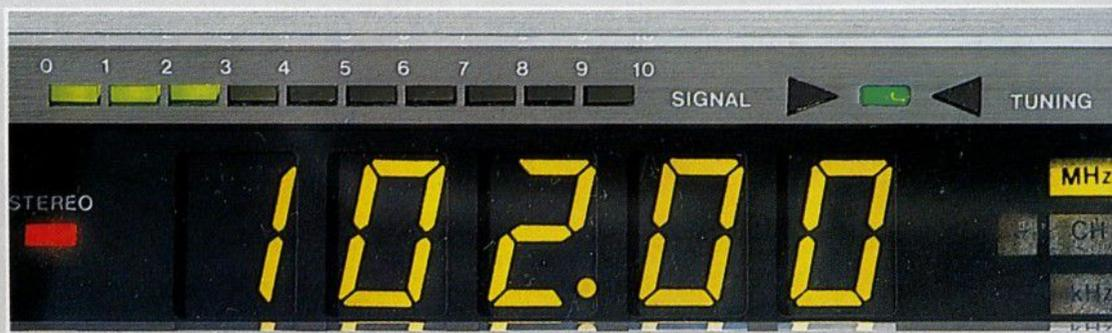
Der AM/FM-Tuner HIFI 8063 stellt die Anwendung modernster Digital-Elektronik dar. Zur manuellen Senderwahl wird über Kurzhub-Tasten (Abb. oben) ein quarzgesteuerter Scanner ausgelöst, der beispielsweise den FM-Empfangsbereich in 50-kHz-Schritten abtastet und bei jeder belegten Frequenz automatisch einrastet. Durch einen 2stufigen Umschalter kann bestimmt werden, ab wel-
