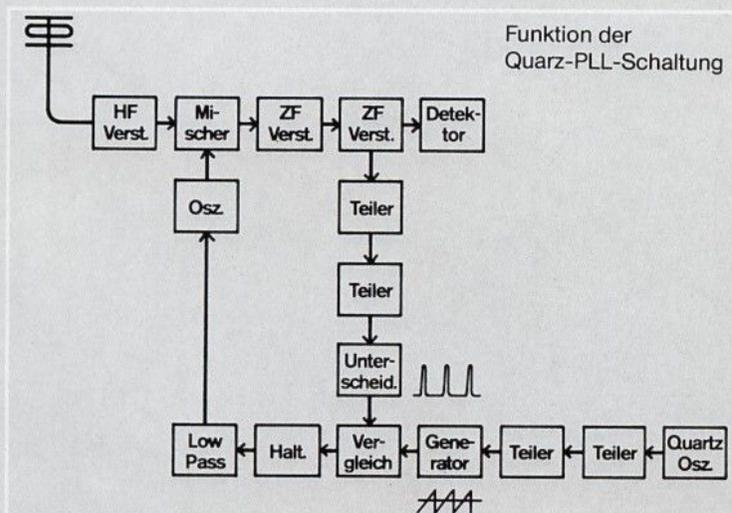
Die quarzgesteuerte FM-Oszillatorschaltung ist das primäre Merkmal, das den AM/FM-Tuner HI-FI 8065 der internationalen Spitzenklasse zuordnet. Ein phasengesteuerter Regelkreis (PLL = Phase Locked
