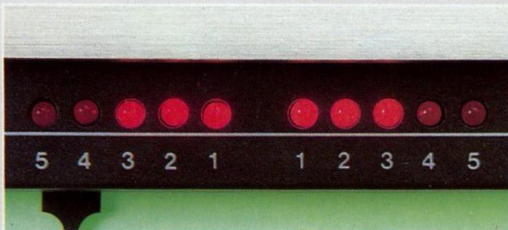
Optischer Anziehungspunkt des Receivers HIFI8033A ist sein 10-stelliges LED-Power-Display, das permanent die abgegebene Ausgangsleistung des 2 x 95-Watt-Verstärkers visualisiert.
