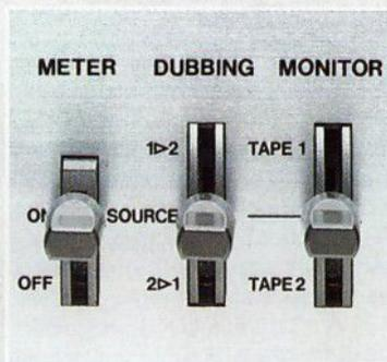
HIFI 8041 bezeichnet einen Vollverstärker (Integrated Amplifier), dessen linearer Frequenzgang und niedriger Klirrfaktor auf einem gleichstromgekoppelten Endverstärker mit kondensatorlosem Lautsprecheranschluß (OCL) beruht. Seine Ausstattungs-Merkmale schließen umfassende Möglichkeiten zur individuellen Klanganpassung und zahlreiche schaltbare Funktionen ein.
