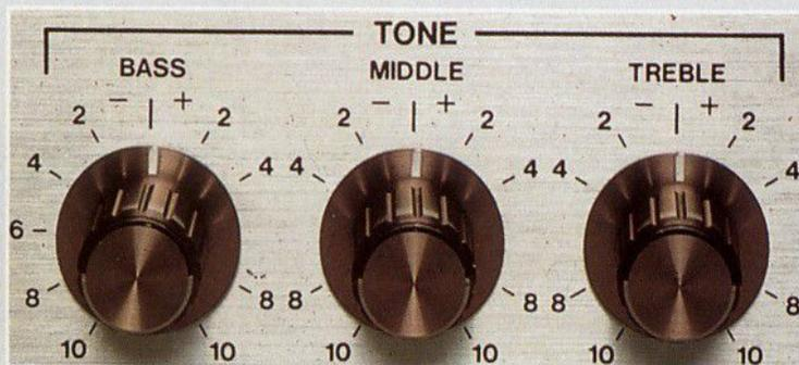
Ein bemerkenswertes Ausstattungs-Merkmal dieses HiFi-Receivers ist sein aufwendiges Klangregel-Netzwerk. Es erlaubt die gezielte Anhebung und Absenkung im Baßbereich bei 40 Hz um  $\pm 16$  dB und im Höhenbereich um  $\pm 13$  dB. Mit dem zusätzlichen Mitten-Regler (Middle), der bei 1000 Hz mit  $\pm 5$  dB wirksam ist, kann die Präsenz des für die Sprachübertragung bedeutenden Frequenzbereiches variiert wer-
